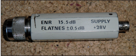
Bild 18: Ein genauer Blick auf die (zwar kleine, aber doch sehr teure) Rauschquelle mit Avalanche-Diode; hier die Seite mit der Angabe des ENRs...
