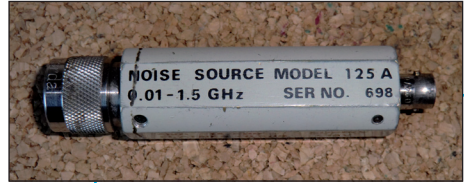
Bild 19:... und hier die nicht weniger wichtige Angabe des nutzbaren Frequenzbereichs
