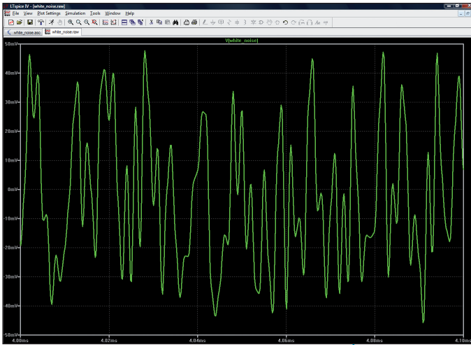
Bild 13: ... und nach dem Zoomen bietet sich das bekannte und typische „Gezappel“ einer Rauschspannung
