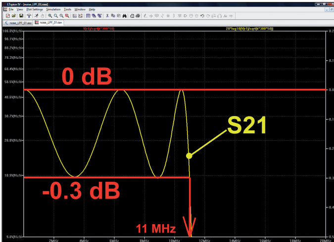
Bild 10: Auch die Darstellung des S21-Ripples im Durchlass-Bereich (= Tschebyscheff-Wellen) zeigt exakt denselben Verlauf wie die vorher durchgeführte S-Parameter-Simulation mit der „Network-Analysis“
